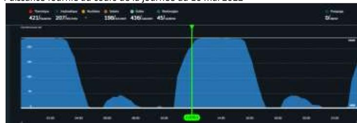
En se référant à la courbe du dessus du 16 mai, on voit qu'à 00 h le bassin se vide, la production est de 230 MW (pour une puissance installée de 240 MW) jusqu'à 3 H 00. Puis elle décroît jusqu'à 4 H 45 où la production s'arrête faute de dénivelé suffisant. La mer a continué de baisser. La production reprend à 5 H 45 jusqu'à 8 H 30 avec une puissance maximale de 44 MW.
